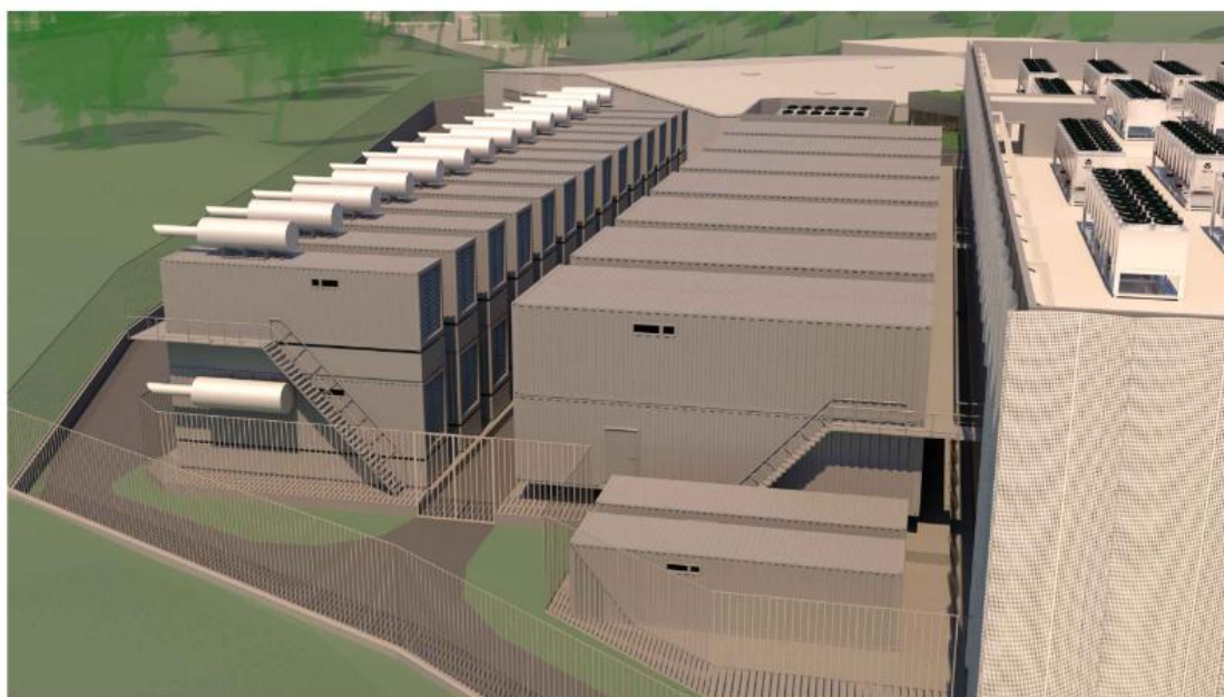
Figur 7. Illustrationsskiss på moduler inom området. Notera att de vita skorstenarna i figuren är vågräta, men de planeras att ställas lodräta.
